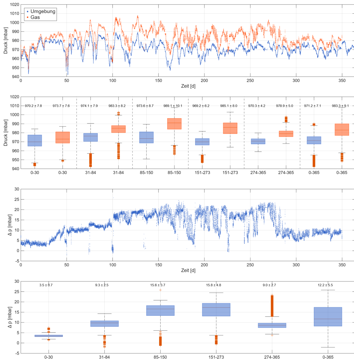
Abbildung 23: Verlauf des Umgebungs- und Gasdrucks
