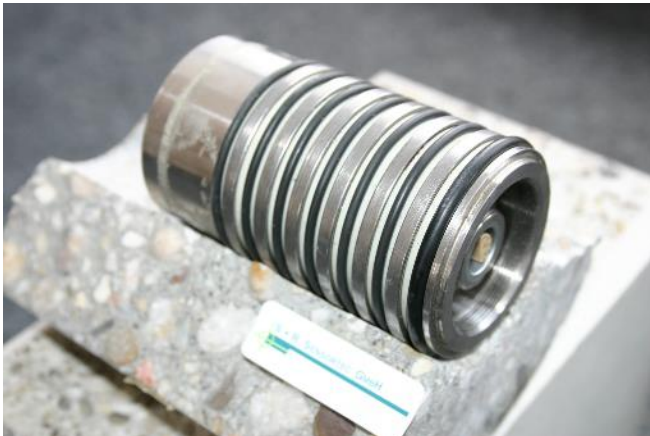
Abbildung 22: Korrosionssensor "Spreizringanode" zur nachträglichen Sensorinstallation an Bestandsbauwerken
