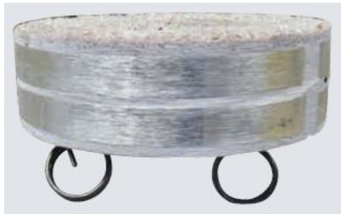
Abbildung 24: CorroDec2G Feuchtigkeitssensor der infrasolute AG, Zug
