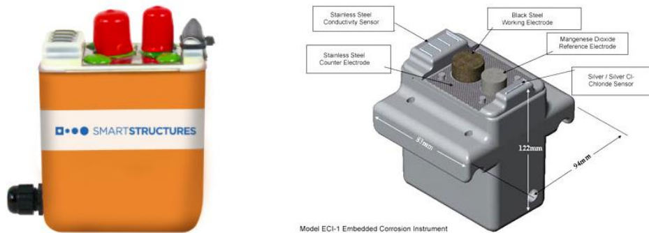
Abbildung 13: Korrosionsmonitoring-System von SmartStructures. Links, ECI-2 und Rechts, ECI-1
