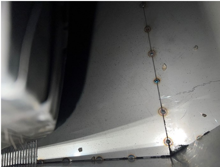
Abbildung 4-11: Reifenpartikel im Absaugtrichter des schweren Nutzfahrzeugs
