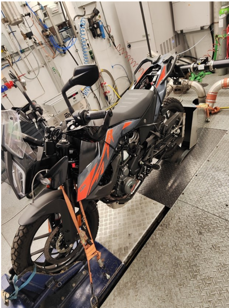
Abbildung 4-13: KTM Adventure 390 Euro 5 am TUG 2-Rad Rollenprüfstand mit aufgebautem Absaugtrichter und Kettenspritzschutz
