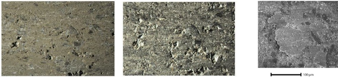
Abbildung 3-2: Bild der Oberfläche eines ECE-Belages nach 30 Schleppbremsungen bei 80 km/h und 38 bar vor (links) und nach Druckluftreinigung (Mitte) aus (Niemann, 2021) sowie eine Rasterelektronenmikroskopische Aufnahme eines ECE Belags nach Bremsungen (rechts)
