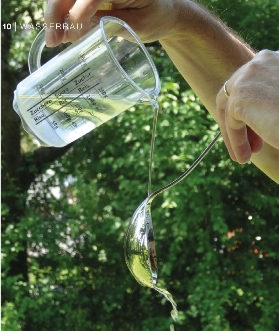
Coanda-Effekt: Das Wasser läuft der Oberfläche des Löffels entlang
