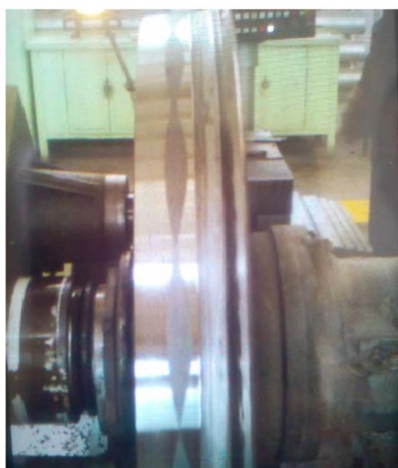
Abbildung 2-3 Beispiel für ein Polygon 18. Ordnung, erwähnt und gezeigt in [24], ursprünglich aus [25]
