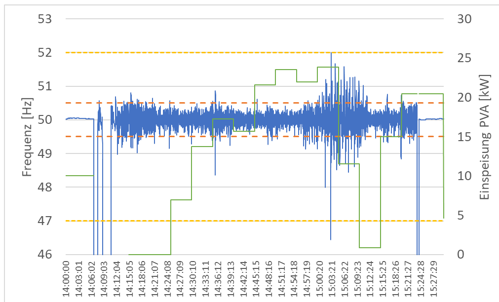
Abbildung 11: Einspeisung der Photovoltaikanlage (in grün) während Feldtest 2
