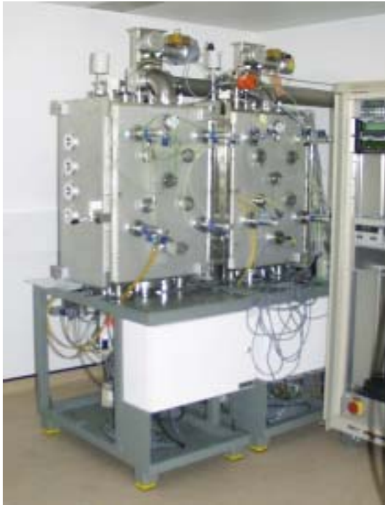
Fig. 1: Installation de dépôt à plasma VHF de l'IMT, à chambre unique 30x30 cm 2 (Projet DOIT, photo IMT / Uni NE)
