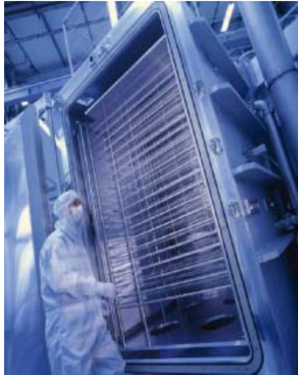
Fig. 2: Installation industrielle de dépôt à plasma (Photo Unaxis)
