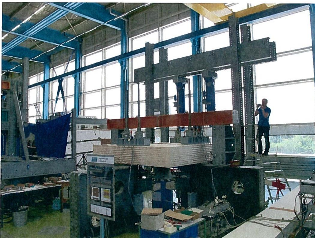
Abbildung 6: Durchstanzprüfung Buche / Fichte kombiniert 400 mm
