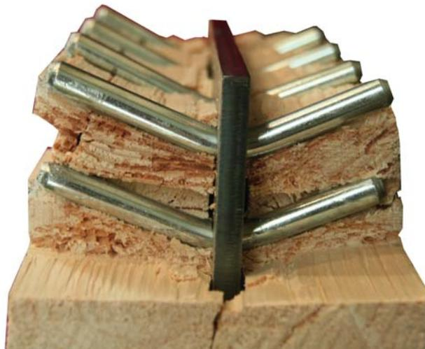
**Fig. 3.8:** Modus 2 Versagen der Verbindungsmittel mit einem plastischen Gelenk im Bereich des Stahlblechs am geöffneten Prüfkörper 06-H-4.
