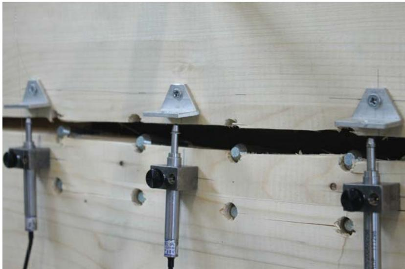
**Fig. 3.10:** Messung der Rissöffnung.
