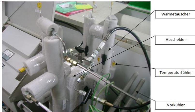
Abbildung 9: In die Anlage integriertes Reinigungsmodul
