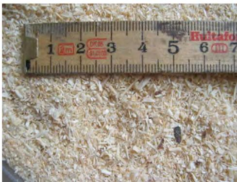
Bild 4.4 Brennstoff: Sägemehl
