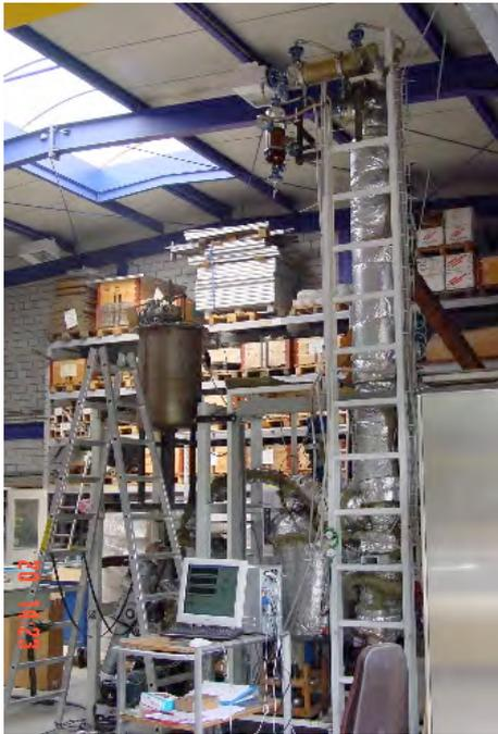
Bild 4.2 Technikumsanlage zur katalytischen Direkt-Verflüssigung von Biomasse mit nachgerüsteter Rektifikationskolonne
