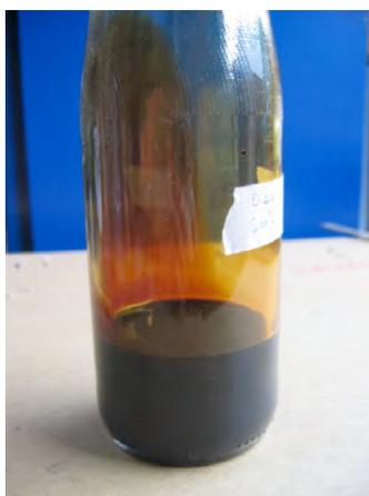
Bild 4.6 Aus der Rektifikationskolonne anfallendes flüssiges Produkt
