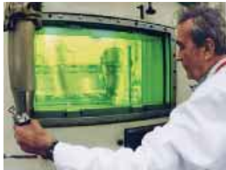
Le Hotlabor du PSI (en haut) étudie les caractéristiques des matériaux des éléments de combustible. Essai d'éclatement d'une section de gaine (à droite).
