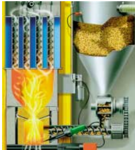
Chaudière à granulés de bois avec silo intermédiaire (Hargassner).
