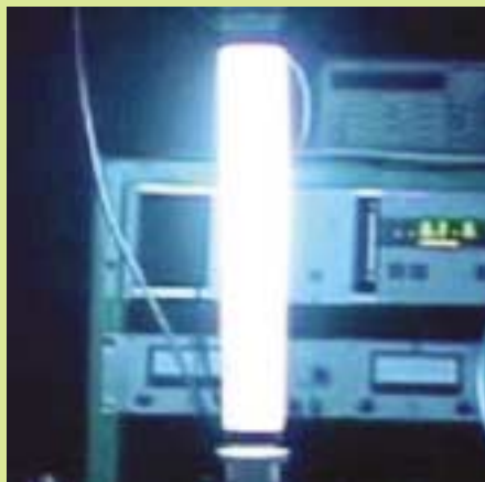
Une lampe à nanotubes de carbone illumine les installations de laboratoire environnantes.
