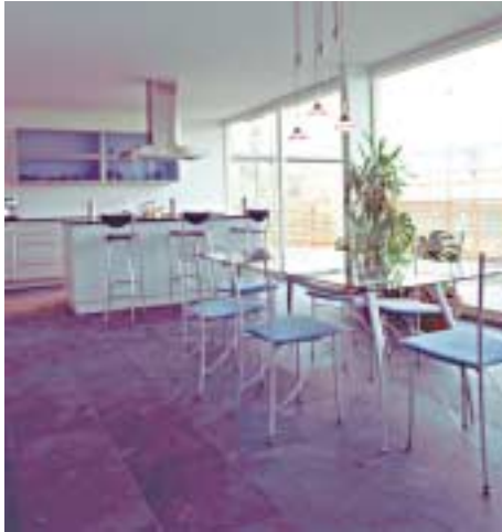
Le sol d'ardoise de Sunny Woods emmagasine la chaleur produite par le rayonnement solaire.
