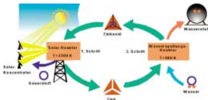
Cycle thermo- chimique pour la production d'hydro- gène à l'aide d'oxyde de zinc.
