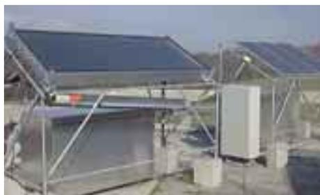
Testaufbau des solar betriebenen Adsorberkühlschranks des LESBAT in Yverdon.
