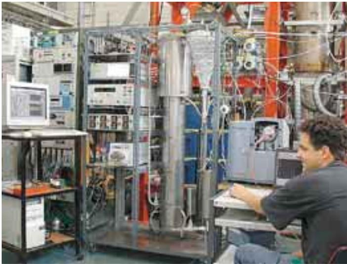
Wirbelschichtreaktor des PSI für Katalysatorentests, die beim Methanisierungsprozess, der Umwandlung brennbarer Anteile im Holzgas zu Methan, eingesetzt werden.
