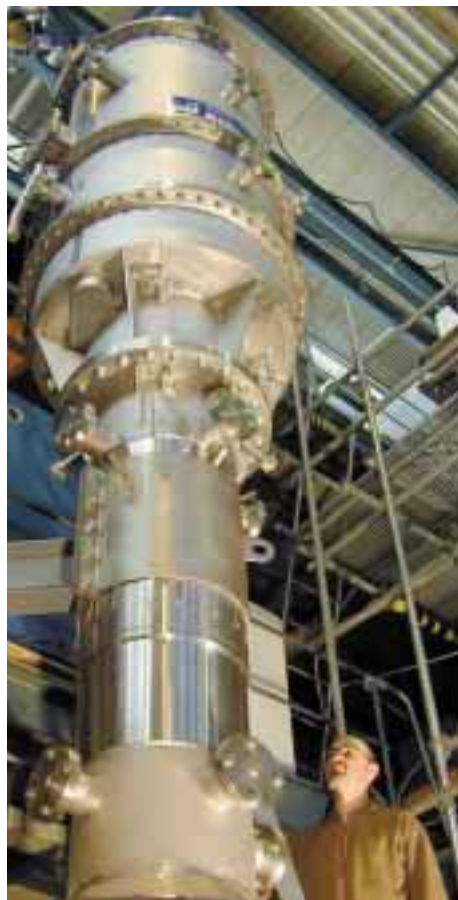
ARTIST-Versuchs- anlage eines Dampf- erzeugers mit Rohrbündel, Trop- fenabscheider- und Dampftrockner- Modul
