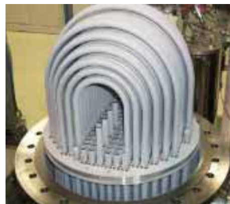
Aerosol-Ablagerungen auf dem Rohrbündel nach dem ersten Test.
