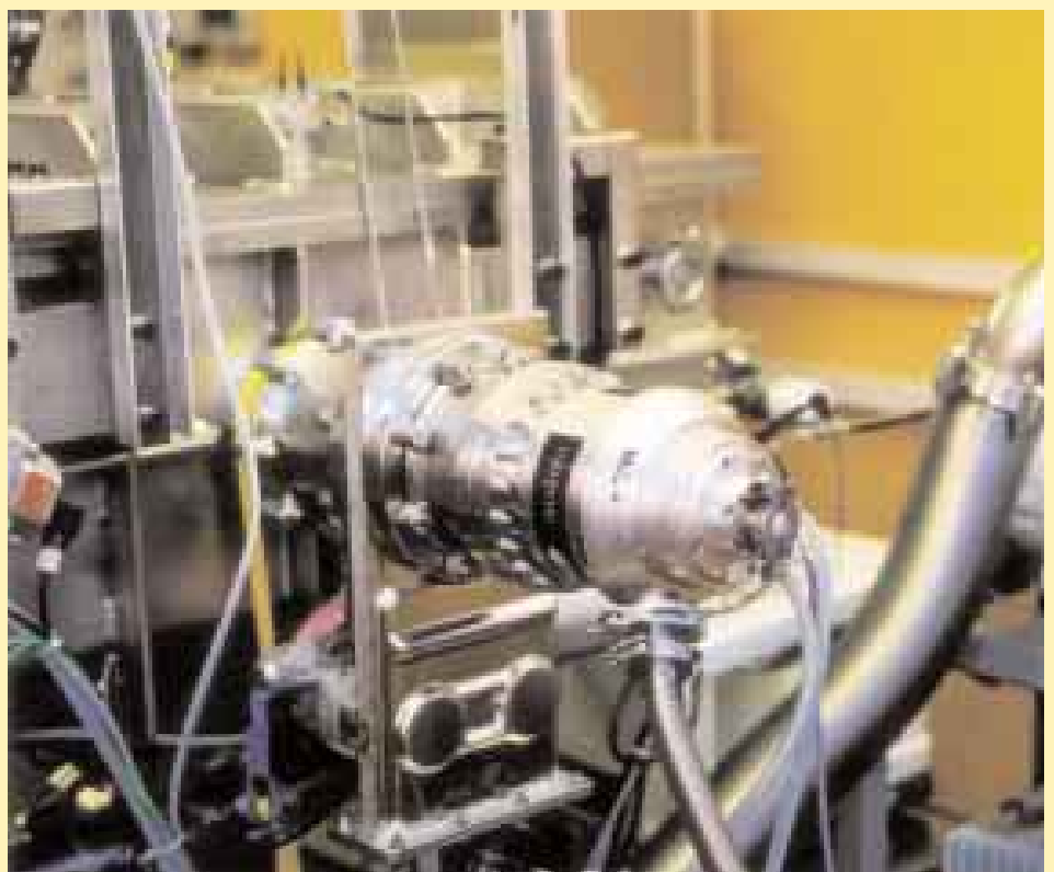
Im Vakuumreaktor durchläuft die Kunststoffolie ab Rolle das hochfrequente Feld für die Silizium-Beschichtung.
