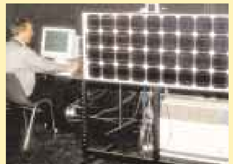
Für Standardprüfungen einzelner Module wird der Impuls-Solar-Simulator eingesetzt.
