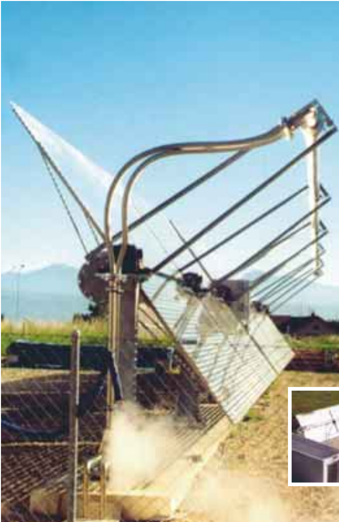
Dieser flache Konzentrier-Sonnenkollektor wurde für den Einsatz bei Hybridsystemen entwickelt.
