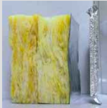
Mineralwolle und VIP (rechts) im Dickenvergleich bei ähnlicher Dämmungsleistung.
