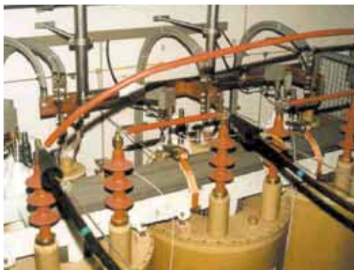
Supraleitender Transformator mit integriertem Strombegrenzer. Gewichts- und Volumeneinsparungen sind Vorzüge dieser Technologie.
