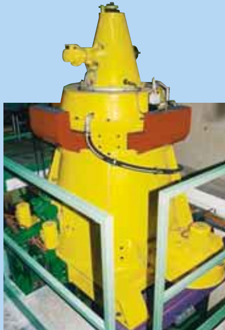
Spezial-Gleichstromgenerator mit direkt gekoppelter Turbine zur Simulation unterschiedlicher Bedingungen.
