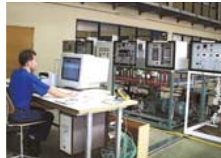
Versuchswärmepumpe an der Fachhochschule Winterthur zur Erprobung von FuzzyWatch.
