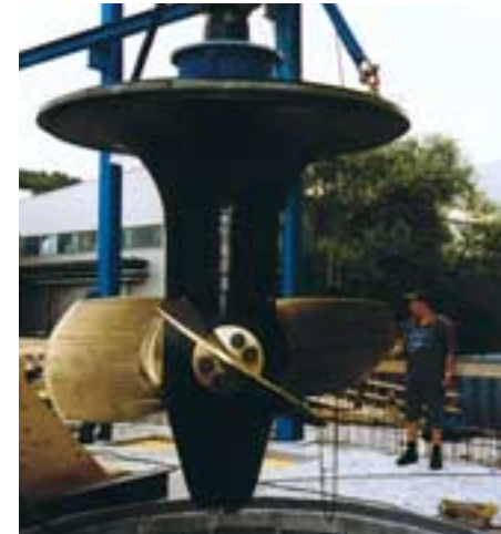
Laufrad mit verstellbaren Leitschaufeln der Kaplan-Turbine.
