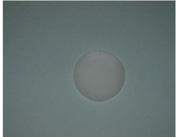
Fig. 3b: MDPE-Probe: MDPE-Probe mit einer 150 nm dicken Al<sub>2</sub>O<sub>3</sub>-Schicht.
