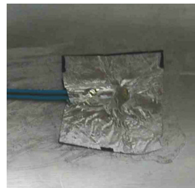
Fig. 3: Oberflächentemperaturfühler eis- seitig auf Aluminiumblech mit emissionsidentischer Abdeckung
