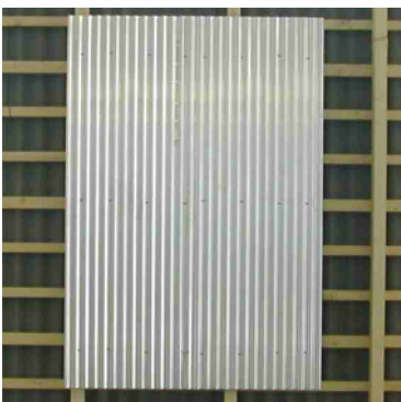
Fig. 1: Unter dem Eternit platziertes, hinterlüftetes Aluminiumblech ohne Perforierung
