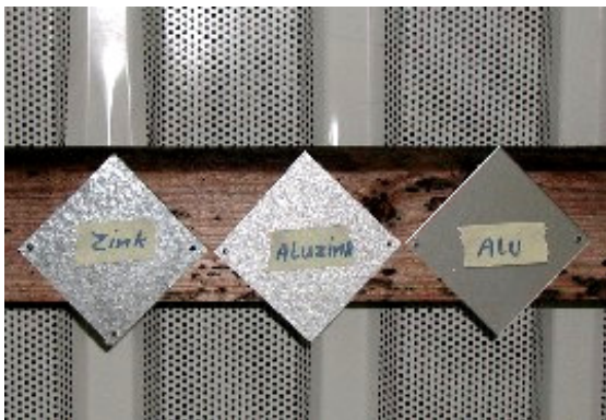
Fig. 1: Die drei verbleibenden Materialien, deren Emissionsverhalten in Funktion der Alterung untersucht wurde
