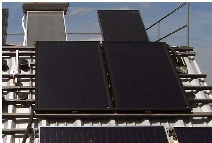
*Fig. 1: Das Bild zeigt die im Teststand installierte Solaranlage. Der drucklose Kunststoffspeicher befindet sich im Systemdachlabor (SDL) in einem der drei temperierten Räume. Die Kollektoren sind auf der nach Süden ausgerichteten Dachschräge von 45° installiert.*
