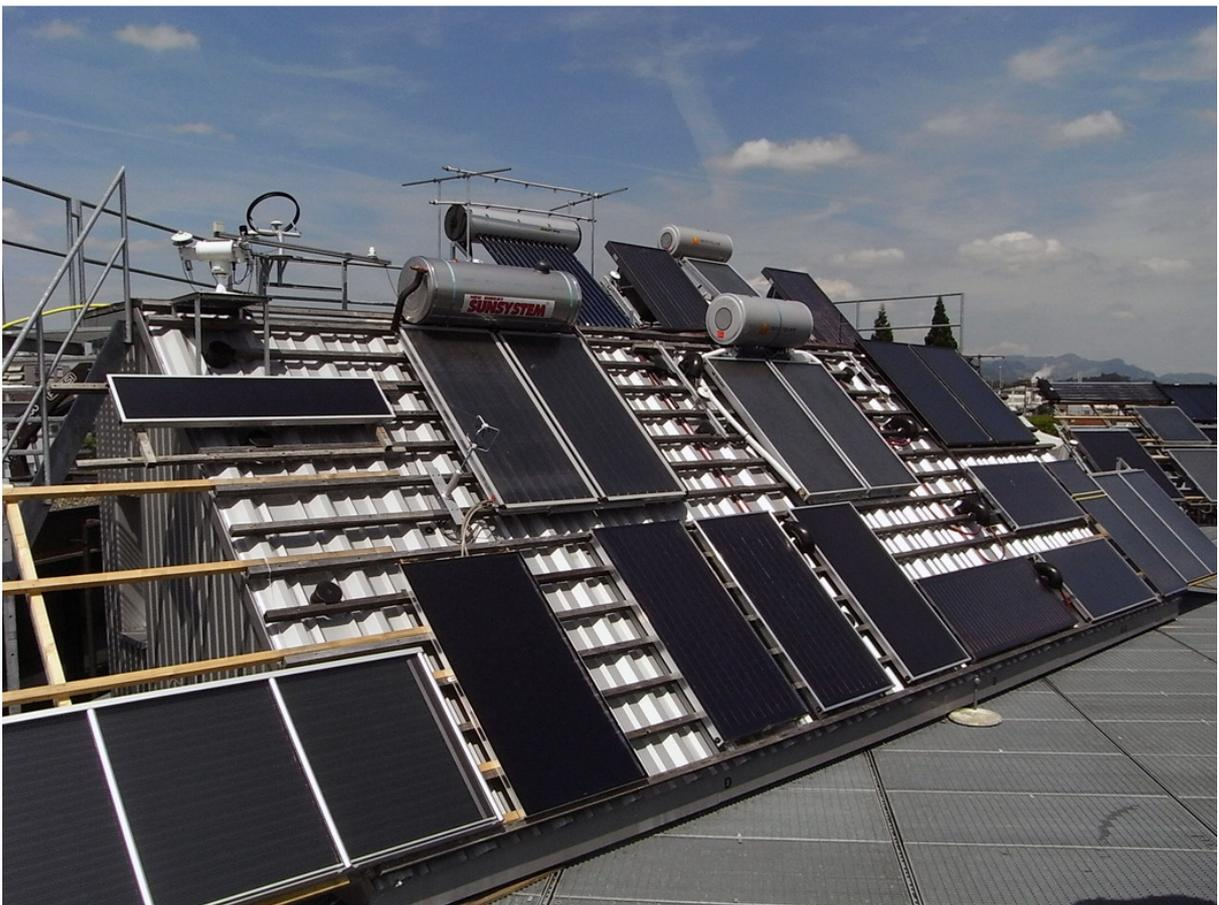
*Fig. 2: Systemdachlabor (SDL) während des Berichtsjahres. Die untere Fläche des Schrägdaches wird für die Kollektorprüfung verwendet. Im oberen Bereich werden die Kollektoren bzw. Schwerkraftanlagen für die Leistungsermittlung und Qualitätsprüfung aufgebaut. Die Speicher von gepumpten Systemen werden in den temperierten Testkabinen im Inneren installiert. Auf dem Flachdach werden Schwerkraftanlagen mit Flachdachaufständerung aufgebaut.*
