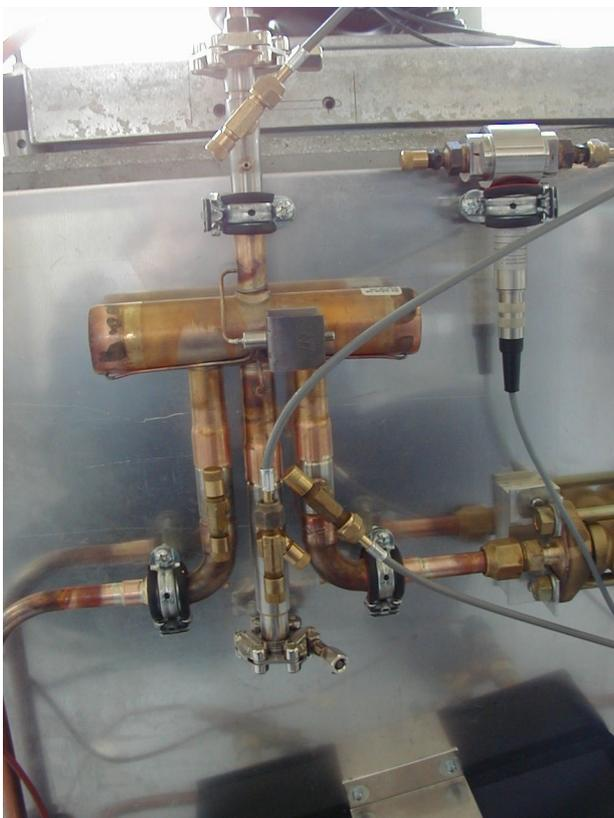
Abb. 17: Vierwegventil am Prüfstand mit den Druck- und Temperaturmessstellen
