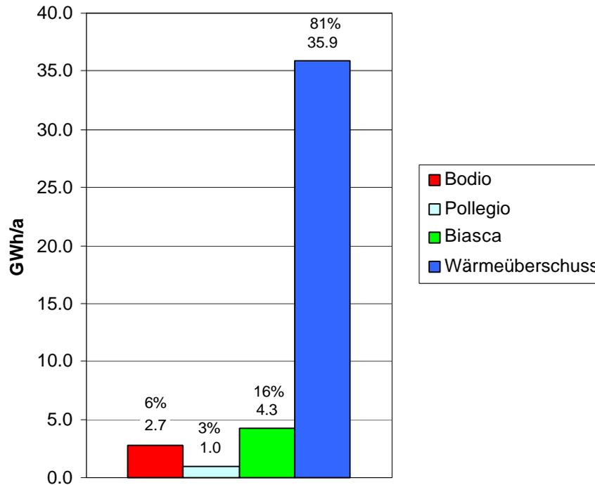
Bild 2: Bergwassernutzungsgrad Gotthard Basistunnel, Südportal
