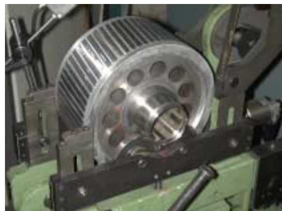
Rotor mit Hohlwelle beim Auswuchten
