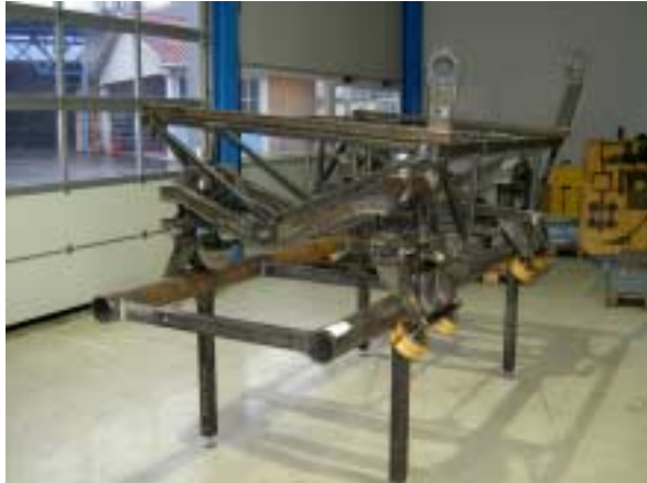
Bild: Fahrwerk im Rohzustand
