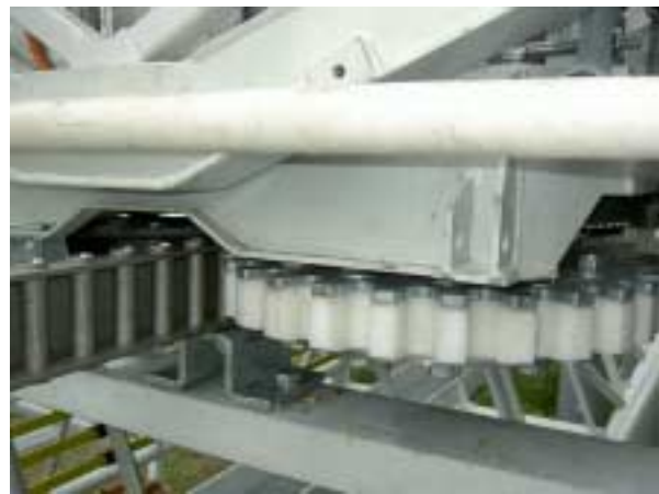
Bild: Kraftschluss mit dem Triebstock
