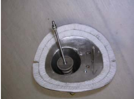
Abbildung 6 Neuer Filtereinsatz, vor Inbetriebnahme von vorne (Quelle: Eigene Fotos)
