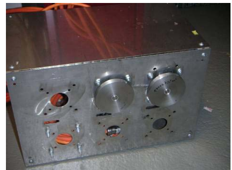
Abbildung 10: Messaufbau: Ueberdimensionierter Transformator, Regler, Motor-Rack
