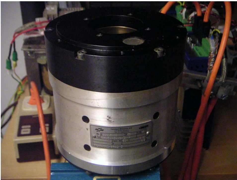
Abbildung 6: Hochpolige Transversalfluss-Servomaschine als Schrittmotor mit 15Nm Dauermoment
