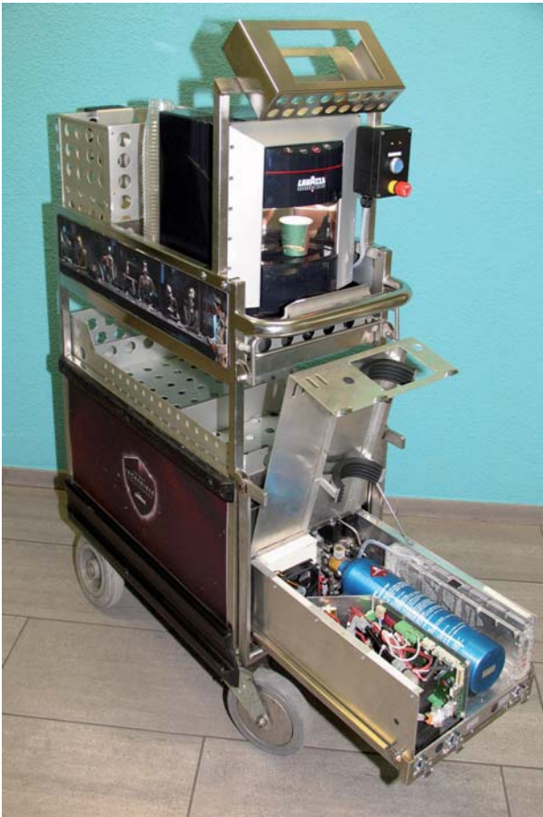
Figur 9: Integration eines PEM-Brennstoffzellenstapels der Firma CEKA in eine Minibar [19, 20].
