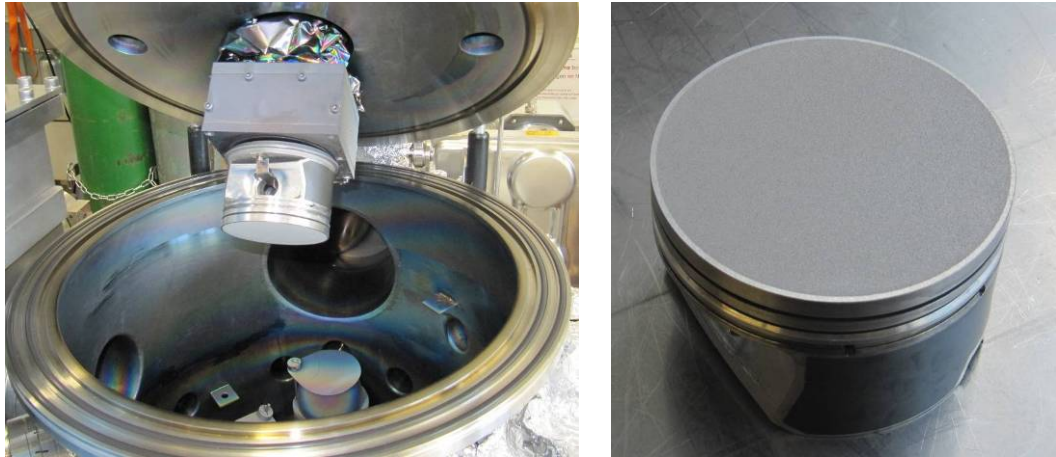
Abb. 8: Kolben in der Sputtering-Anlage (Empa Abteilung „Nanoscale Materials Science“), fertig beschichteter Kolben
