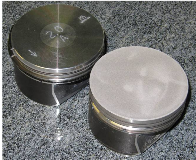
Abb. 4: Erster Beschichtungsversuch der Kolben (links ein unbeschichteter Kolben)
