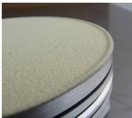
Abb. 5: Kolben nach dem Aufspritzen der TBC Schicht durch die Nova Werke AG
