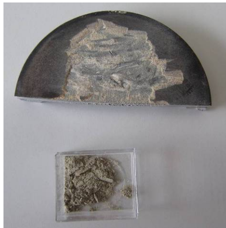
Abb. 16: Für die Thermogravimetrische Messungen mechanisch entfernte Kolbenbeschichtung
