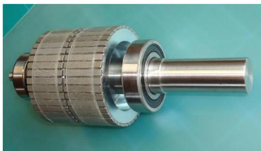
Foto 4: neuer Rotor mit Neodymmagneten bestückt
