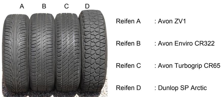
Abbildung 4 CPX-Reifen gemäß ISO/CD 11819-2
