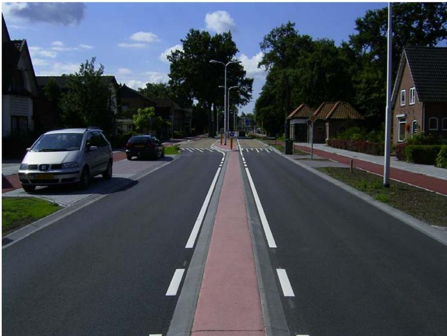
Abbildung 5 *Dünne Deckschicht*
