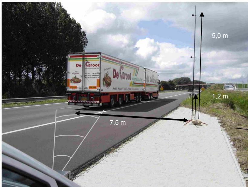
Abbildung 2 Messaufstellung zur Feststellung des Schallpegels gemäß der SPB-Methode
