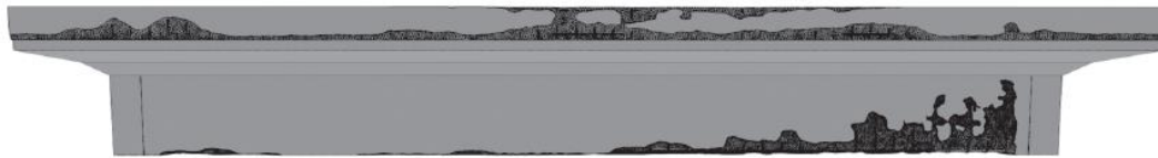
Abbildung 121: Darstellung von Schäden in BIM am Beispiel von (Isailović et al., 2020).
