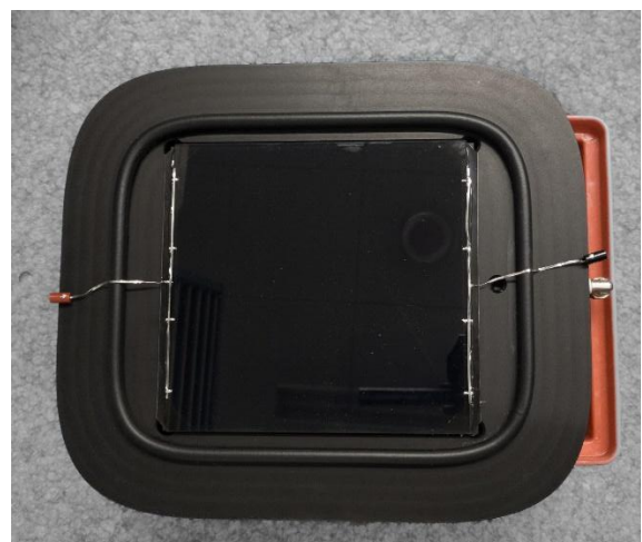
Abbildung 5: Variante 2: Überarbeiteter Vakuumhalter mit SunPower Zelle
