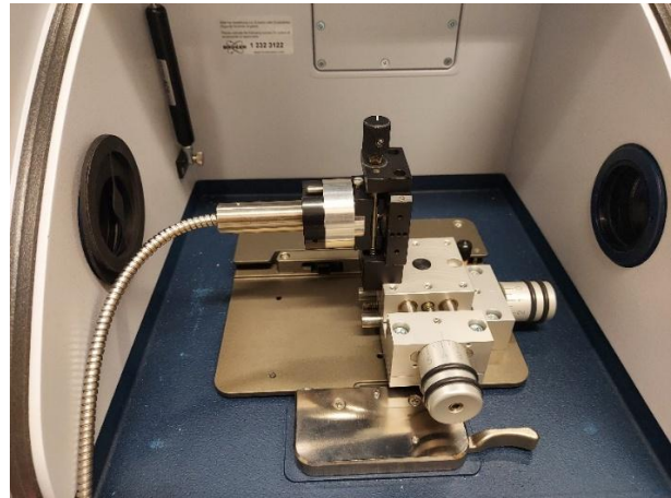
Abbildung 9: 3-Achsig justierbare Faser-aufnahme im Probenraum des FTIR zur Auskopplung der Lichtquelle.
