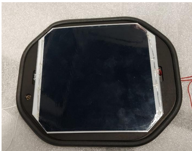
Abbildung 4: Variante 1: Lamierte und kontaktierte SunPower Zelle im Vakuumhalter
