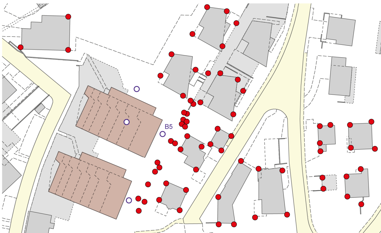
Abb. 3: Ausschnitt aus dem Kontrollplan; violett: Inklinometer, rot: geodätische Messpunkte.
