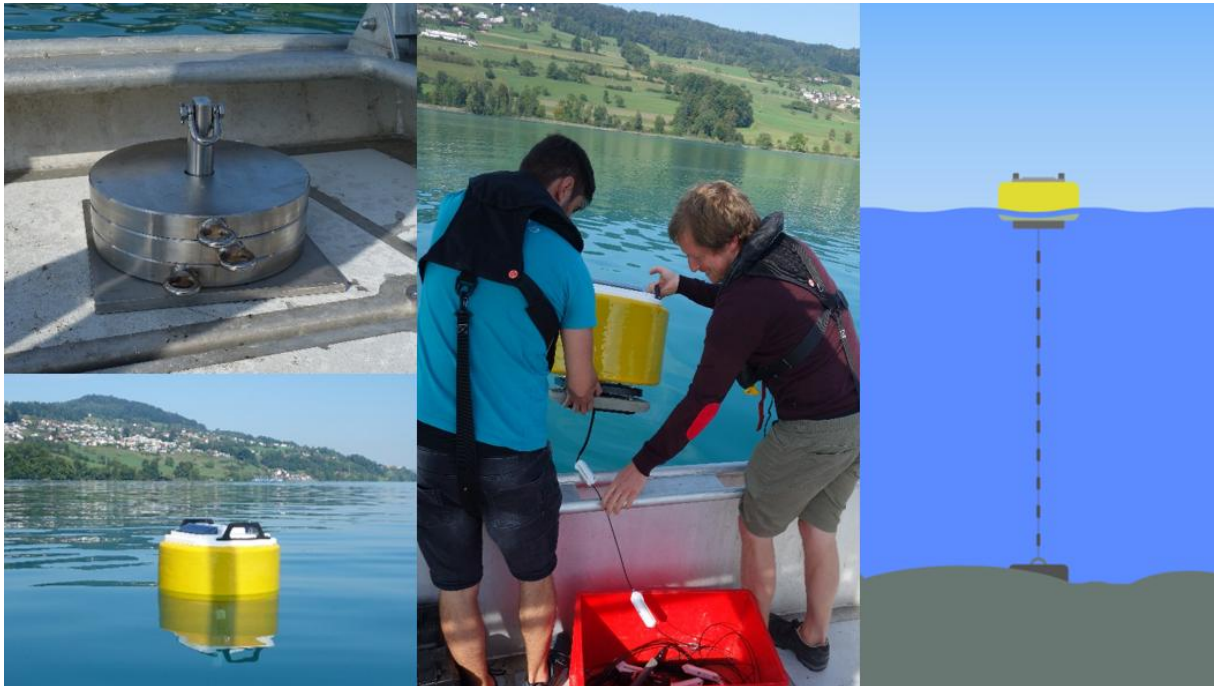
Abbildung 28: Messkette Hallwilersee: 65-kg Stahlanker (links oben), Messboje im Wasser (links unten), Einsetzung der Boje und Sensoren an Stahlseil (Mitte), Schema der Verankerung mit Boje, Sensoren an Stahlseil und Anker (aber ohne Metallkette zwischen Messkette und Anker). Fotos und Schema: BAFU.
