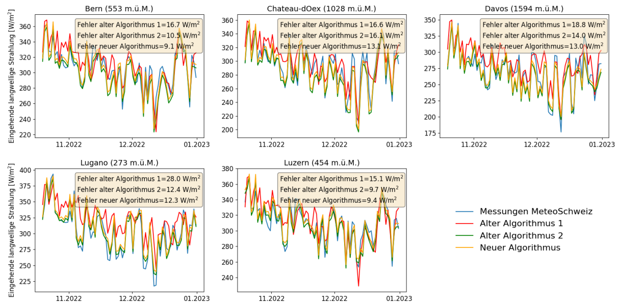
Abbildung 49: Vergleich von Messdaten der eingehenden langwelligen Strahlung von MeteoSchweiz mit dem alten (Dilley-Unsworth mit beobachteter und berechneter Wolkenbedeckung) und dem neuen Algorithmus (Dilley-Crawford mit Wolkenbedeckung berechnet aus Sonneneinstrahlung)
