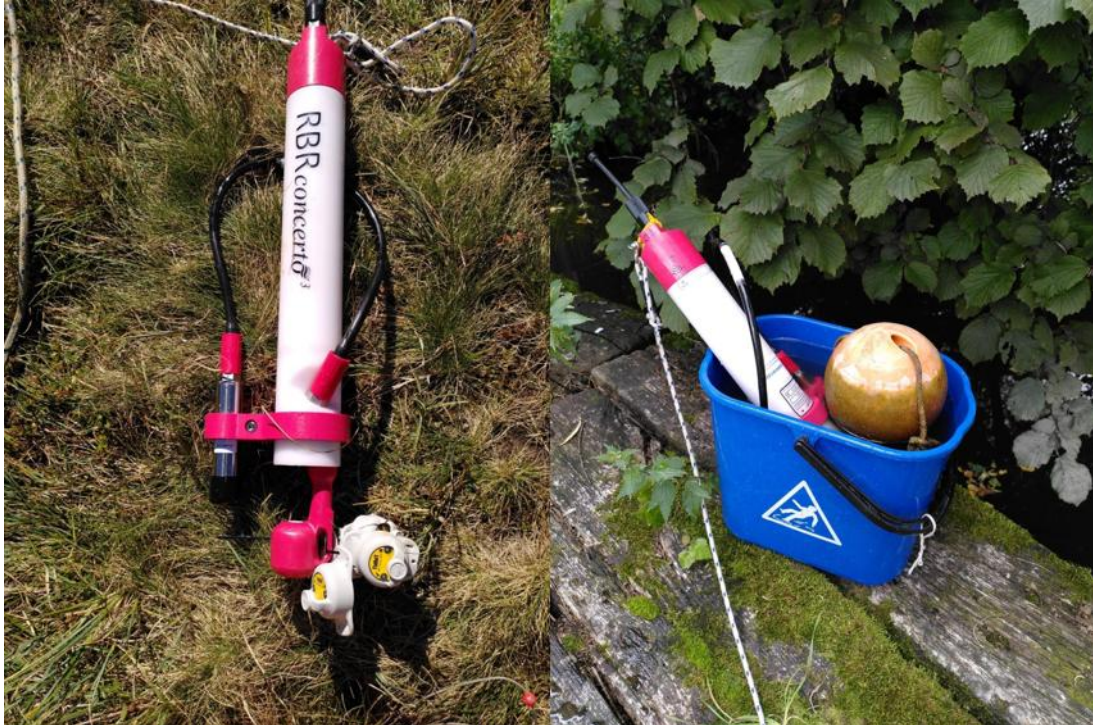
Abbildung 26: Hochgenaue CTD-Sonde mit Hobo-Loggern für Kalibration im Kleinsee (links); CTD und Hobo-Logger in einem Eimer für Feldkalibration (rechts)
