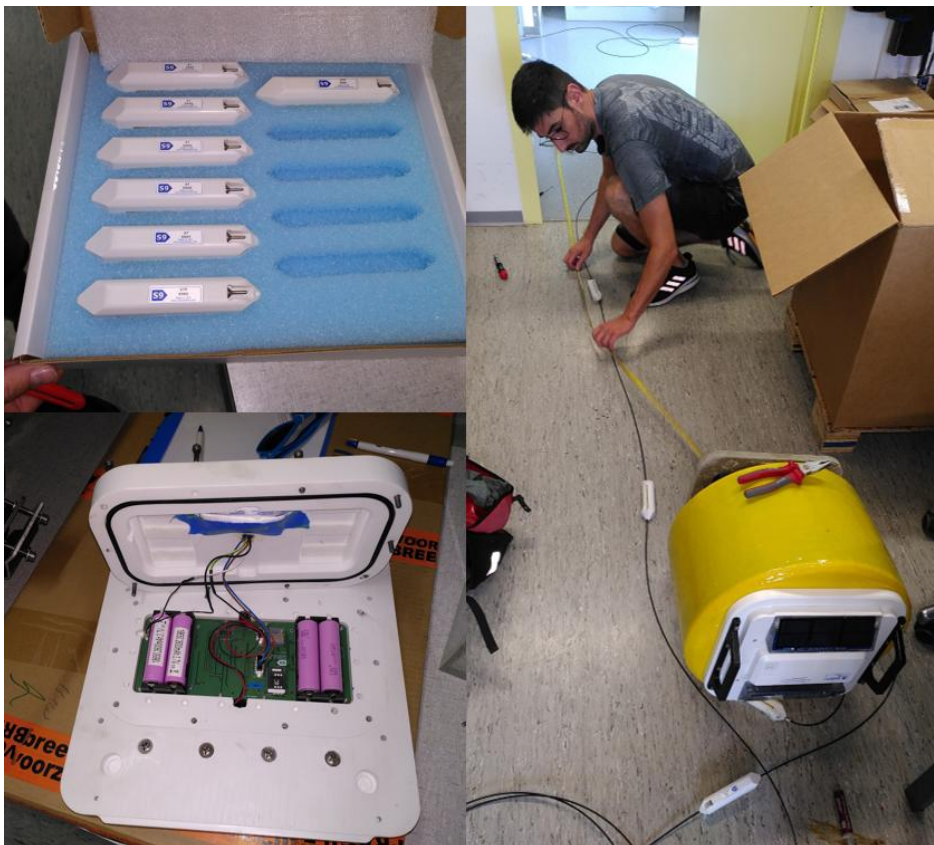
Abbildung 27: Einzelne gelieferte Sensoren (links oben), Innenleben des Controllers mit Akku-Batterien (links unten) und Vorbereitung Messboje mit Befestigen der Sensoren (rechts)
