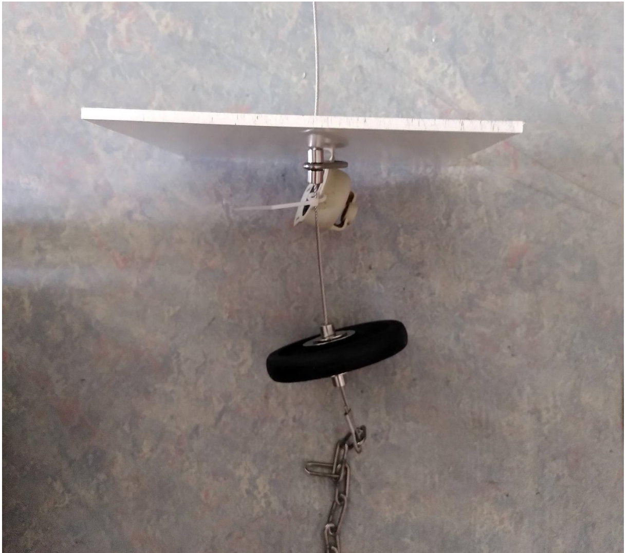
Abbildung B 1: Unterster Sensor mit PVC-Platte zur Beschattung und 0.5 kg Hantelscheibe als Gewicht, um das Stahlseil gespannt zu halten im Wasser. Die 4mm Stahlkette unterhalb ist flexibler und gleichzeitig schwerer und garantiert so, dass sie, (ausser vielleicht bei starkem Wind, am Seegrund liegt.
