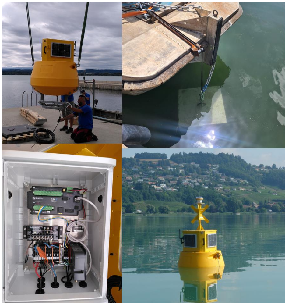
Abbildung 31: Vorbereitung der Messboje durch Mitarbeiter der Firma Intrastub (links oben), Ankergewicht (oben rechts, Foto: Intrastub), Innenleben der Controller-Box (links unten), eingesetzte Messboje (rechts unten, Foto: T. Herold)
