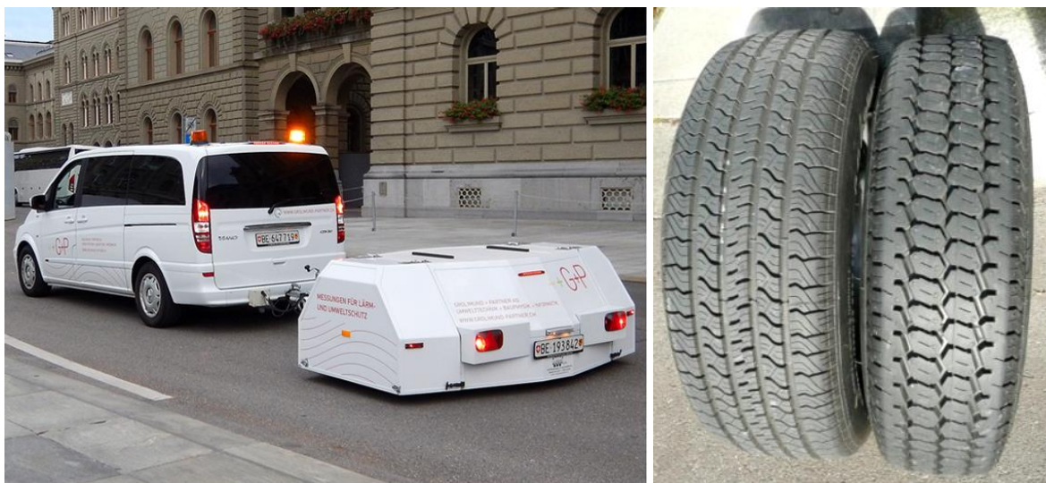
Abbildung 12: G+P Messsystem und CPX-Testreifen P1 (links) und H1 (rechts) gemäß SN EN ISO 11819-3:2021.
