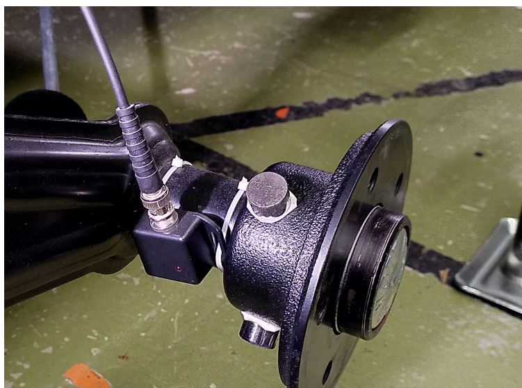
Abbildung 16: Sensor (schwarzes Gehäuse mit Kabelanschluss) und Permanentmagnete (silbern) an der linken Radnabe des CPX-Anhängers.
