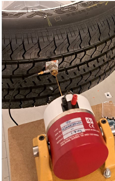
Abbildung 29: Verbindung zwischen Shaker, Kraftsensor und Reifen.
