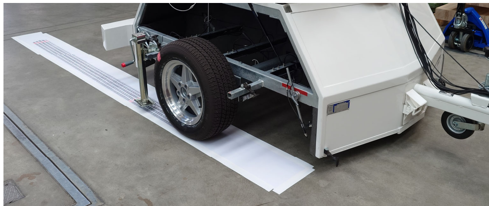
Abbildung 22: Abdrucknahme des SRTT-Profiles unter Anhängerlast auf glattem Untergrund. Die klebende Seite des weissen Papierstreifens lässt die dunkle Kreide anhaften. Der 4 m lange Streifen wurde mit Klebeband auf dem glatten Betonboden fixiert.
