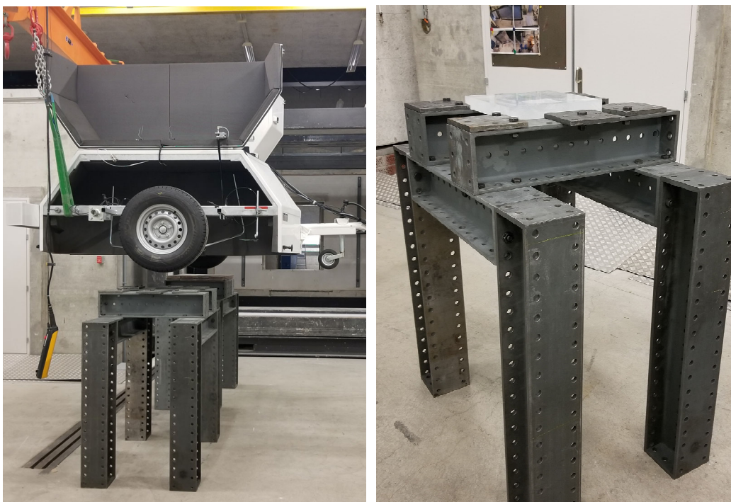
Abbildung 25: Versuchsaufbau zur statischen Kompression der Profilrillen.
