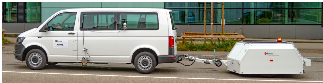
Abbildung 5: Messzug für CPX-Pegel (im Anhänger) und Belagtextur (am Zugfahrzeug).
