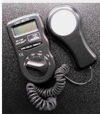
Abb. 7. Im Projekt eingesetzte Messmethode für ALAN. Luxmeter VOLTcraft MS-1300 zur Messung von lokalem Umgebungslicht im Freiraum (links). Das Diagramm (rechts) zeigt die Charakteristik der spektralen Empfindlichkeit des VOLTcraft MS-1300.
