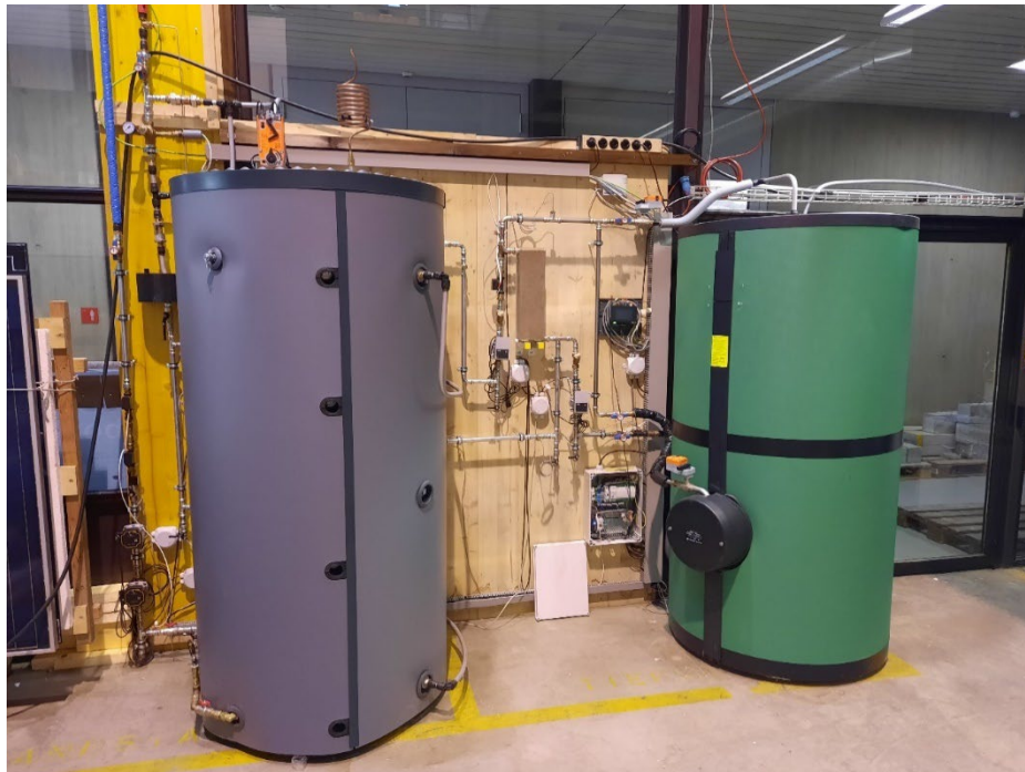
Abbildung 9: Laboranlage mit Solarspeicher (grau) und Boiler (grün). Zwischen den Speichern ist die Umladestation und die Anlagensteuerung montiert, links vom Solarspeicher die Verrohrung des Solarkreises.
