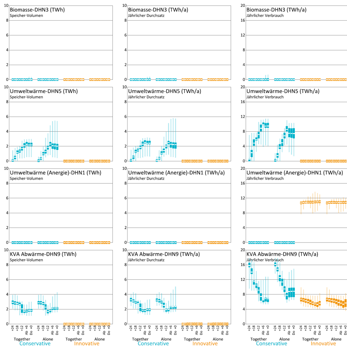
Abbildung 84: Ergebnisse der Energiesystemmodellierung für Varianten der Grundszenarien, Einheit und Bedeutung der y-Achse in der jeweiligen Überschrift, die Werte auf der x-Achse entsprechen den Klimazielen, die erreicht werden sollen, mit +24 bis +0 Mt CO 2 -äq pro Jahr, Ab = Abroad, Do = Domestic.
