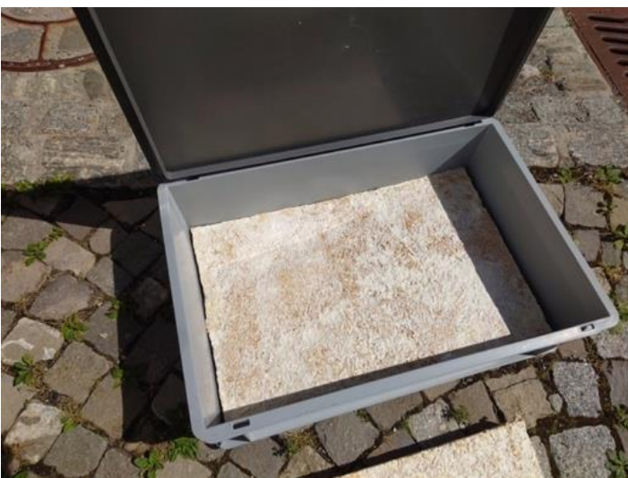
Abbildung 5: Formgewachsene Myzelplatte – direkt in einem technischen Behälter kultiviert, ohne weitere Formgebung.
