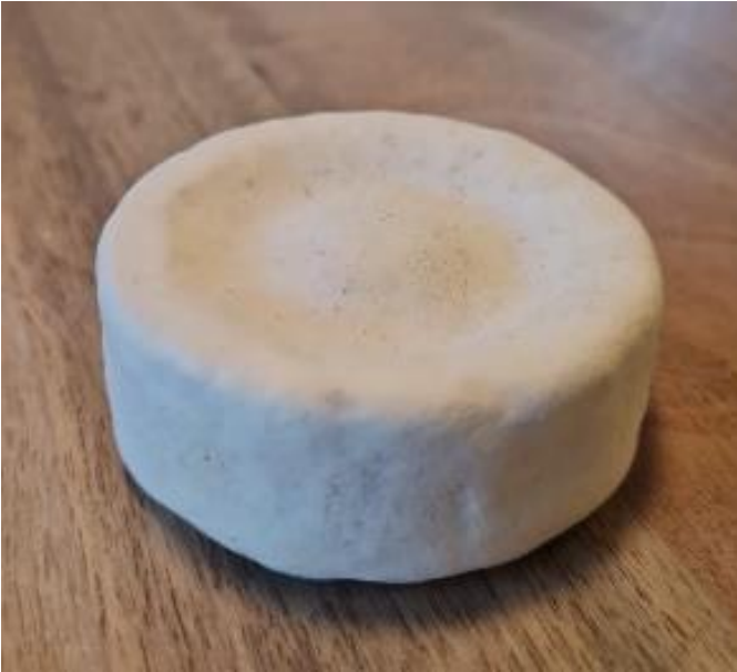
Abbildung 2: Die Grundlage für die Entwicklung von strukturellen Dämmplatten, bildet das homogen gewachsene Myzelmuster der Firma Mycrobez AG.
