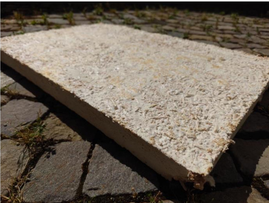
Abbildung 7: Myzelplatte mit teilkolonisiertem Holzsubstrat – Darstellung natürlicher Fasereffekte.
