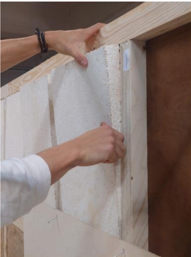
Abbildung 10: Detailansicht der Verbindung zwischen Myzeliumkern und Holzrahmen – Untersuchung von Haftung und strukturellem Übergang.
