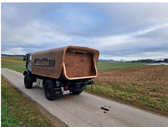
Abbildung 13: Timcelium-Kabine auf mobilem Fahrgestell – Beispiel für modulare und temporäre Anwendungen im Leichtbau.
