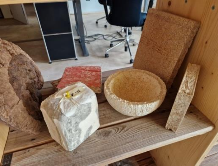
Abbildung 3: Formvielfalt und Dichteveränderungen von Myzelprodukten – Potenzial für modulare Bauanwendungen.
