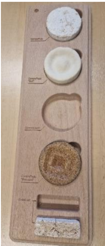
Abbildung 1: Zylinderförmiger Myzelprototyp unter kontrollierten Wachstumsbedingungen – Untersuchung von Dichte, Textur und Festigkeit.
