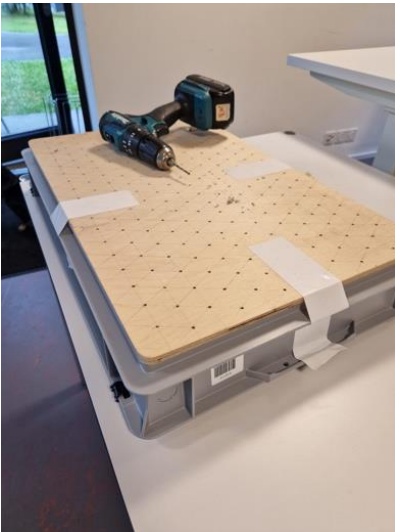
Abbildung 4: Vorrichtung zur mechanischen Prüfung und Bearbeitung von Plattenmaterial mit Lochraster.
