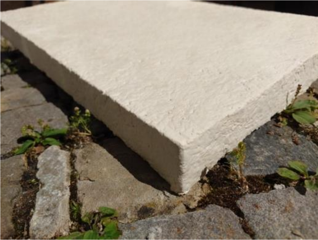
Abbildung 6: Nahaufnahme einer vollständig ausgehärteten Myzelplatte mit optimierter Oberflächenstruktur.
