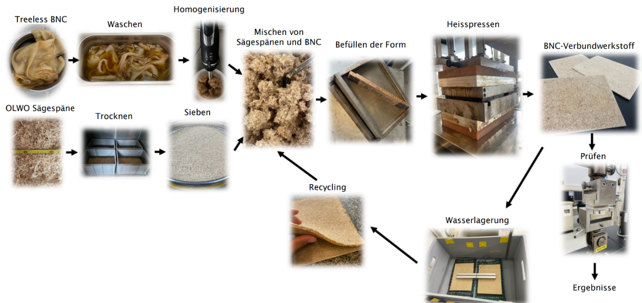
Abbildung 9: Schritte zur Herstellung und Recycling von BNC-Verbundwerkstoffen
