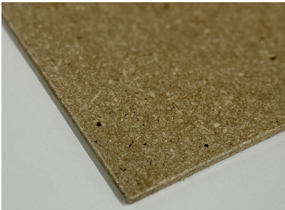
Abbildung 10: BNC-Verbundwerkstoff hergestellt mit dem Heisspressverfahren
