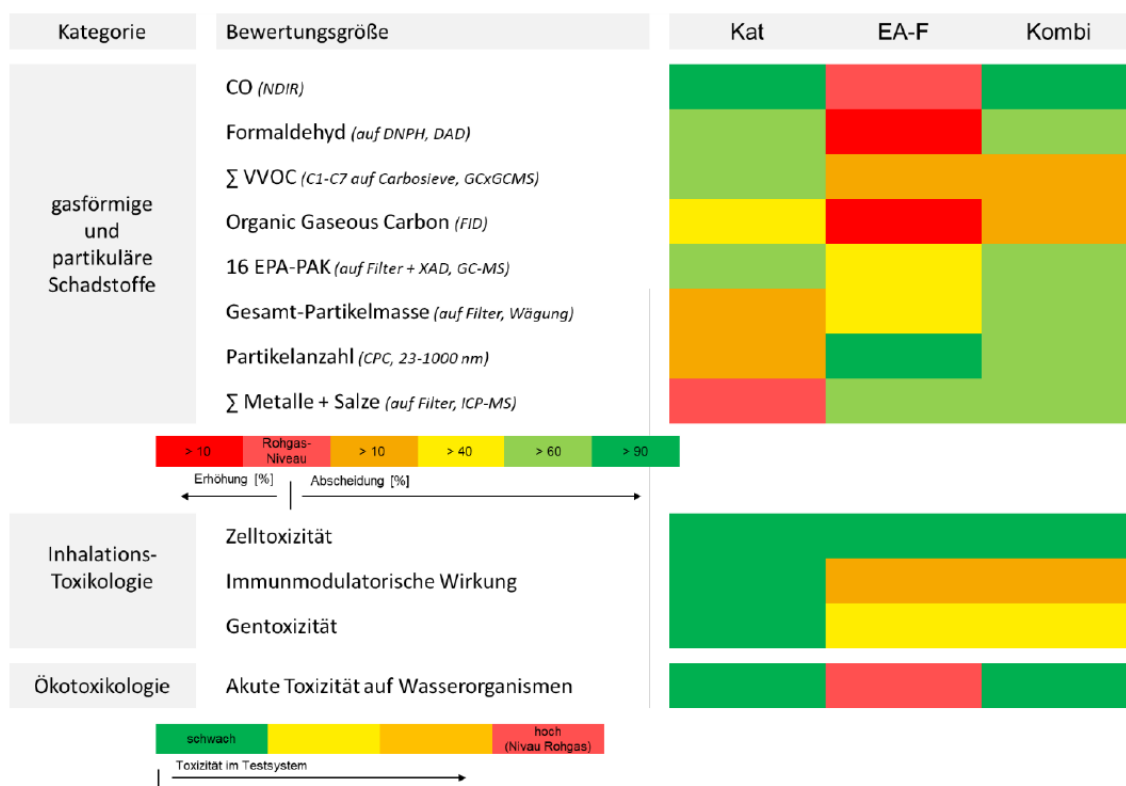
Abbildung 29: Matrix zur Wirksamkeit der untersuchten Minderungstechniken Katalysator (Kat), E-Abscheider (EA-F) und Kombination beider Verfahren (Kombi) sowie zu den human- und ökotoxikologischen Effekten (stark vereinfacht)
