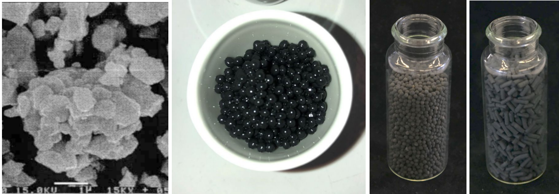
Abbildung 38: SEM Katalysator Herstellungsschritte
