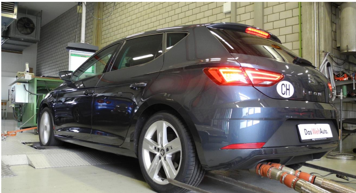
Abbildung 4: Versuchsfahrzeug Seat Leon am Rollenprüfstand.
