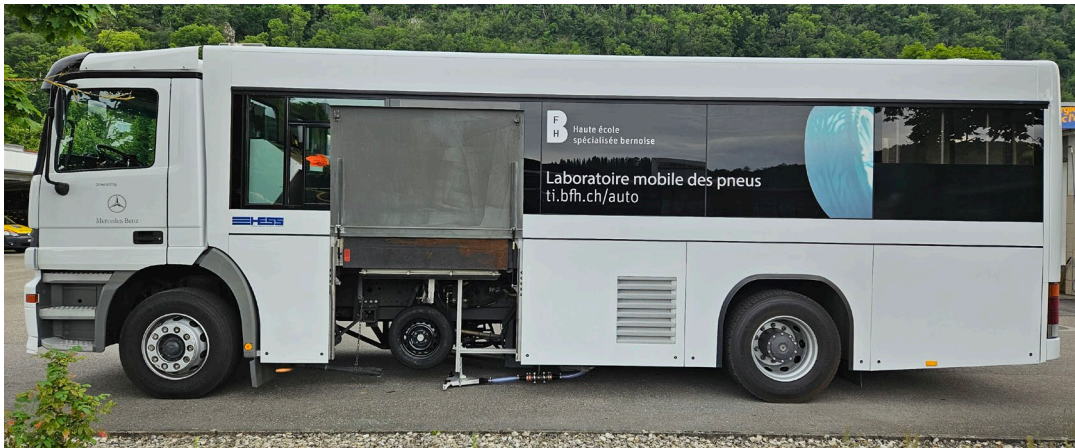
Abbildung 1 : Versuchsbereites MoReLab-Fahrzeug mit eingebauter Prototypen-Partikelabsaugung
