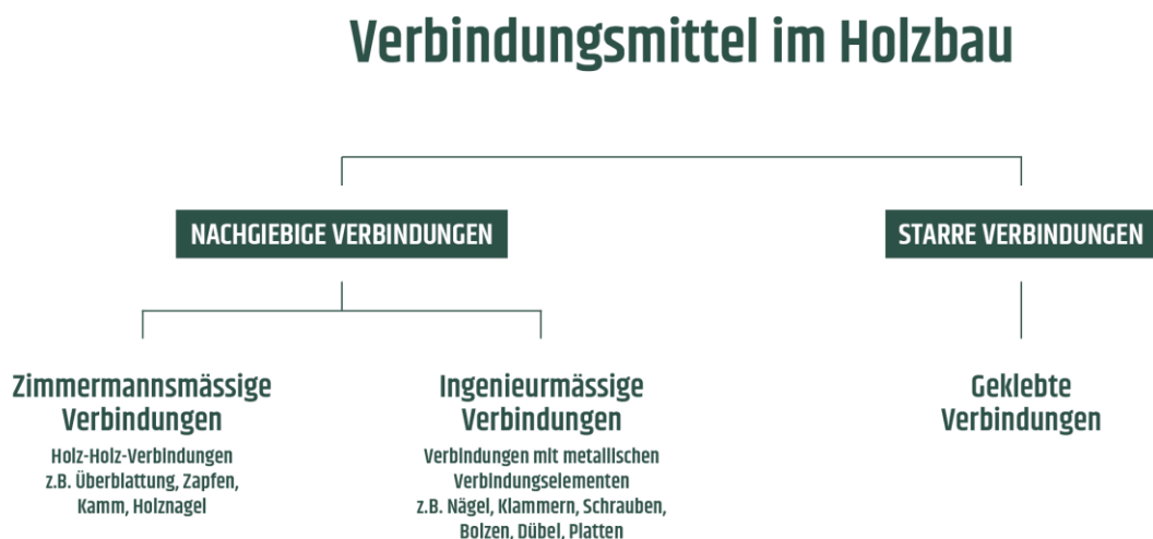
Abbildung 20: Einteilung Verbindungsmittel im Holzbau Quelle: PIRMIN JUNG Schweiz AG
