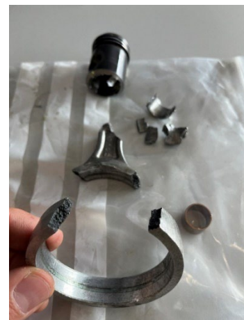
Abbildung 12: Zerbrochene Pleuellstange des unteren Pleuellagers
