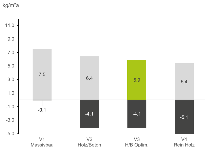
Abbildung 10 Treibhausgasemissionen der untersuchten Varianten für die Erstellung von Haus C, bezogen auf die Energiebezugsfläche und die Lebensdauer des Gebäudes; Gebäude ohne Gebäudetechnik (BKP 2 exkl. BKP 23, 24 und 25); grün: Haus C wie realisiert; schwarz: im Holz gebundenes CO 2 .
