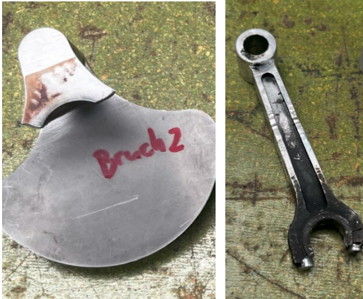
Bild 10: Gebrochene Kurbelwelle + Pleuelstange
