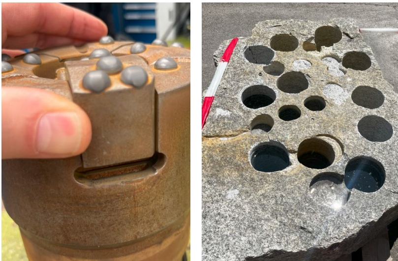
Bild 9: Bohrkopf, Laborbohrungen im Granit (v.l.n.r)
