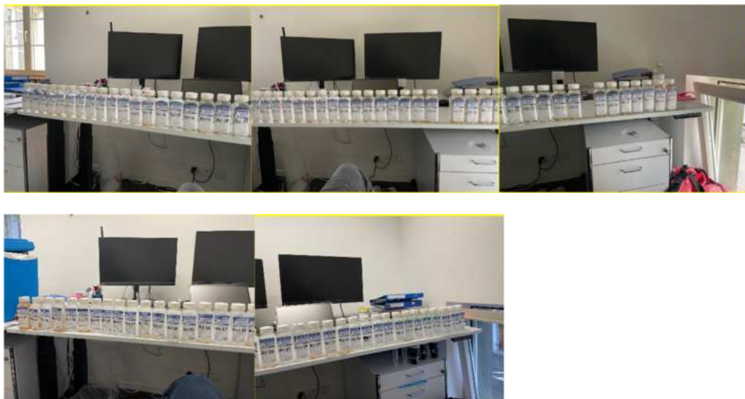
Abbildung 24 Probenahmegefäße der Hydrantenproben 1 bis 61. Die Wasserproben aus Hydranten sind vielfach braun verfärbt. Dies lässt auf Korrosion und Stagnation schließen.
