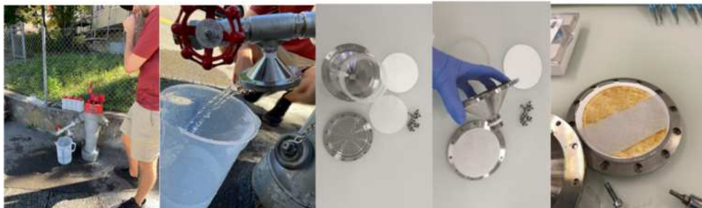
Abbildung 3 Hydrantenadapter am Hydranten angeschlossen mit Filterhalter für die Membranfiltration von 10 bis 150 Liter.
