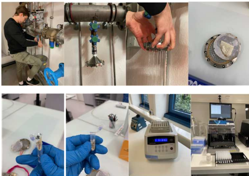
Abbildung 28 Allgemeiner Ablauf der Filterbeprobung mit anschliessender DNA-Extraktion und DNA-Nachweis. Möglichst nahe beim Hauseingang wird der Filterhalter mit Membrane an einem Probenahmehahnen mit Standardgewinde montiert. Es werden ein Probenvolumen von bis 50 bis 500 Liter durch den Filter gespült. Die Membrane wird im Labor aus dem Filterhalter montiert und gemäss Promega-Standardprozedur wurde die DNA direkt von der Membrane extrahiert und mit dem Maxwell-Gerät aufgereinigt. Anschliessend wurde die extrahierte DNA mit ddPCR analysiert. Die ddPCR ist gegenüber Inhibition robuster als die qPCR.
